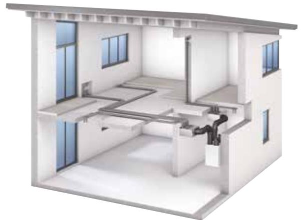
**Zentrale** Lüftungsanlagen haben ein zentrales Lüftungsgerät, das die Frischluft durch ein Luftverteilsystem an die Räume leitet. Sie eignen sich besonders für **Neubauten**, denn die Ab- und Zuluftkanäle müssen in die Gebäudeplanung miteinbezogen werden. Schlagen Sie zwei Fliegen mit einer Klappe, indem Sie die zentrale Lüftungsanlage mit einer Wärmepumpe kombinieren. Dies sorgt energiesparend für ein warmes Haus und zugleich frische Luft.
